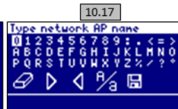
10.17 Vælg det ønskede netværk. Indtast kodeordet i pop-up-tastaturet. Brug op-/ned-tasterne og venstre og højre med plus-/minus-tasterne. Tryk OK for at vælge et bogstav
