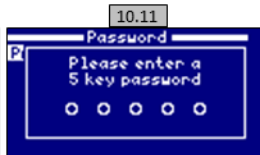
10.11 Kodeord: Beskytter adgang til brugermenuen ved at aktivere et kodeord. For at taste dit kodeord, tryk på en kombination af 5 taster, så husker systemet det. Hvis du glemmer kodeordet, er der et master-kodeord. Spørg din installatør/forhandler.
