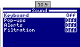
10.9 Lyd: Programmer systemet til at udsende lyd for funktionerne: Tastatur (taster); Notifikationer (pop-up-beskejer); Alarmer (arbejdsalarm); Filtrering (Start på filtrering).
