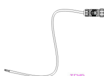
Varmepumpe 485-kabel X1
