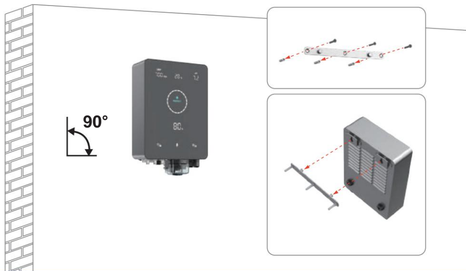
3: Montering af styreboks
